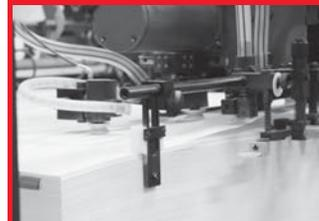
圧搾空気と負圧を利用して、積み重なった枚葉紙を1枚ずつ引き上げ、印刷ユニットに送り込みます
