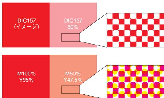
図キャプション：左の図の上段はDIC157 (イメージ) の網点、下段はDIC157をプロセス変換した網点の比較です。DIC157ベタと変換後のM 100%、Y 95%で差はあまりなくても50%になると差が歴然とします。
