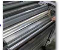
インキ壺。ここにインキを充填させて印刷する。
